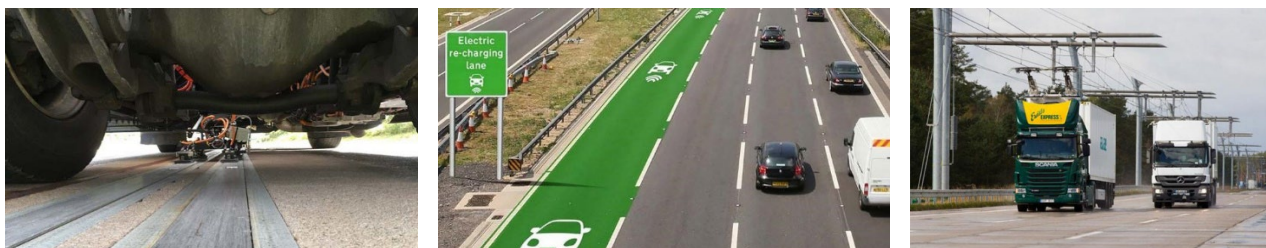
Figure 13 : trois technologies de route électrique : alimentation par le sol (Alstom), induction (ElectRoad), et caténares (Siemens)
