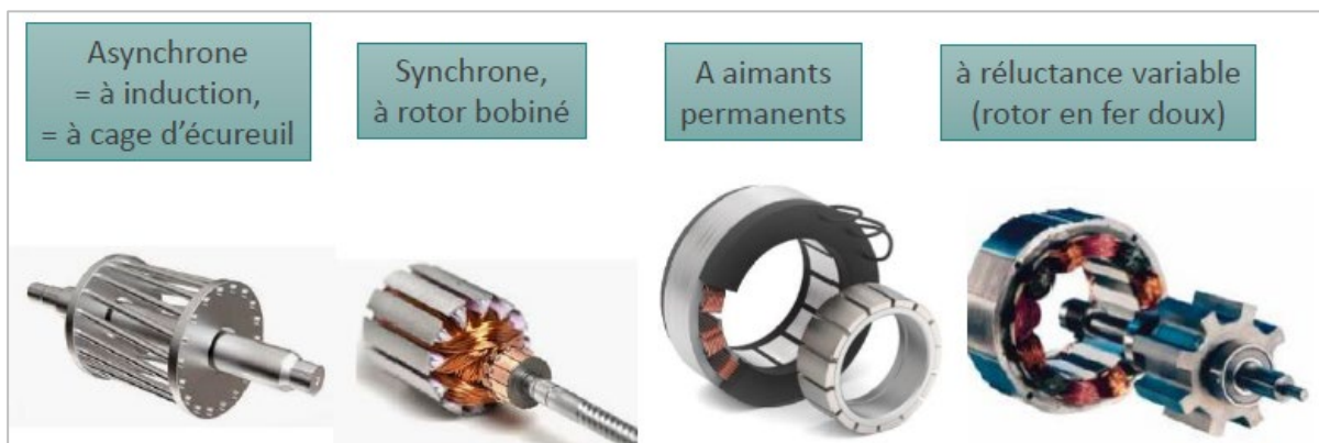
Figure 18 : présentation des différents types de rotors
