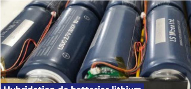
**Hybridation de batteries lithium avec des supercondensateurs**
