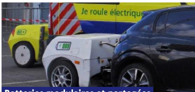
**Batteries modulaires et partagées pour véhicules électriques**
