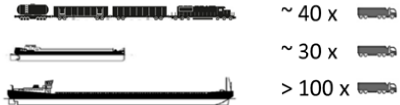
Comparatif entre les charges moyennes observées en France pour le train et deux types de bateaux fluviaux, par rapport aux poids-lourds articulés (source ADEME pour fluvial, MTES pour train, IDDRI pour camions).
