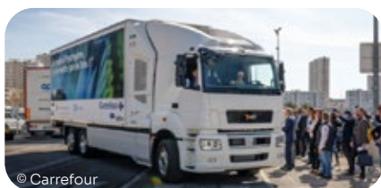
Camion rétrofité H2 pour Carrefour dans le cadre du projet CATHyOPE
