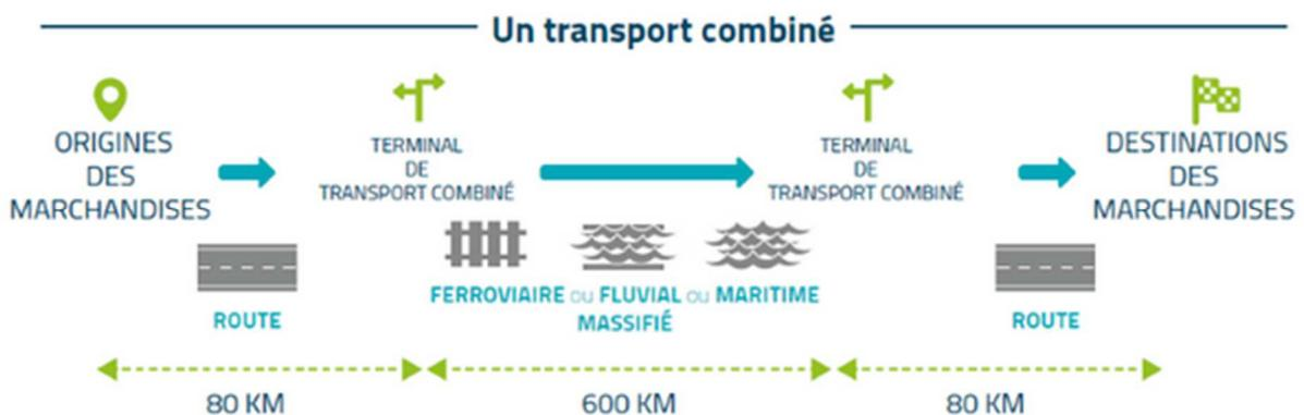
Figure 1 : schématisation d'une chaîne de transport de semi-remorques
