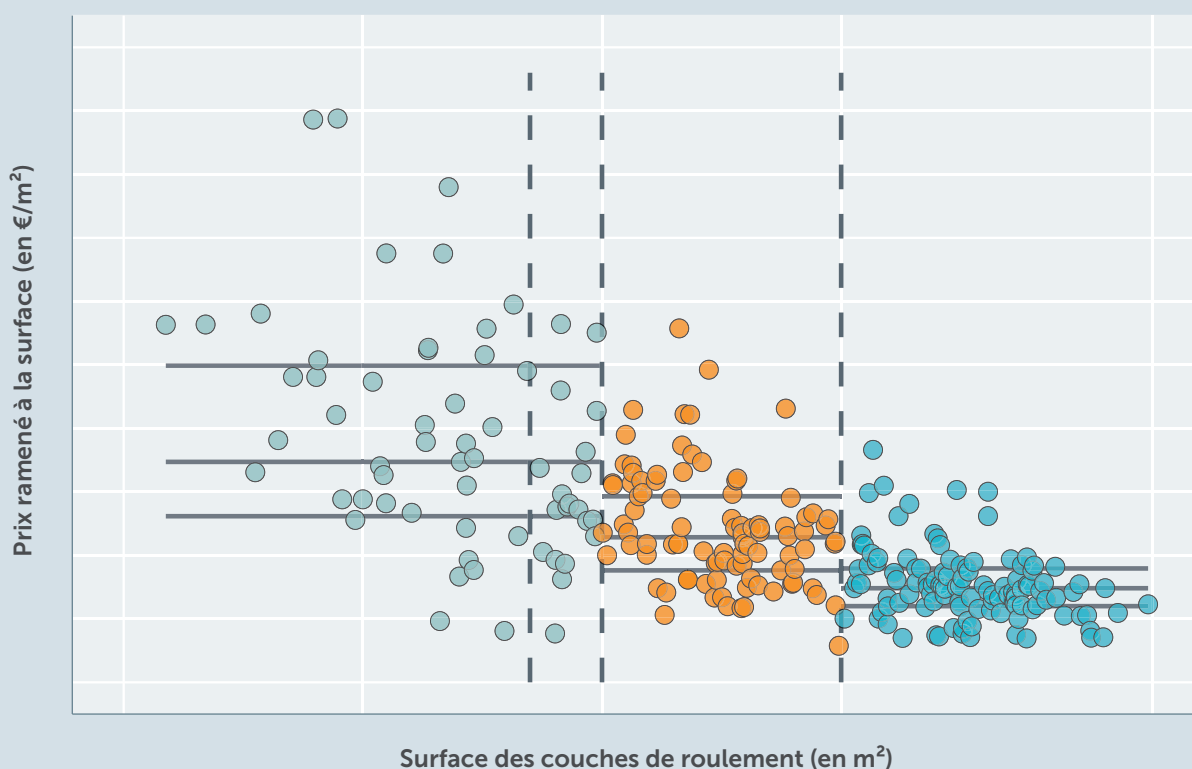
Figure 12 - Variation du prix de couche de roulement en fonction de la surface mise en œuvre 87
