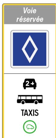
Figure 3 : signalisation d'information de la VR2+ largeur réduite.
