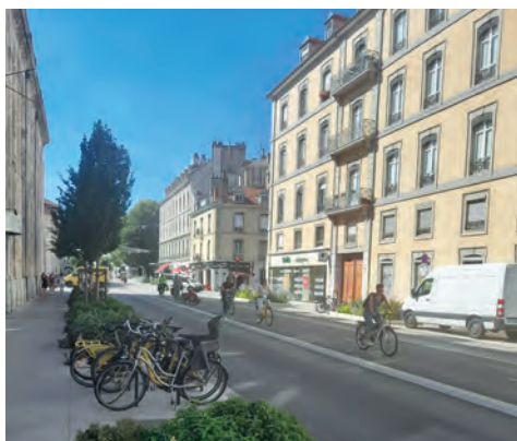
Aménagement en section courante avec une piste cyclable axiale
