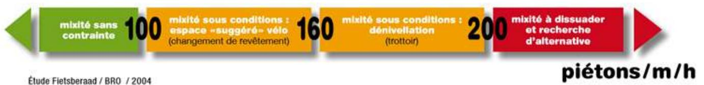
Figure 9 : Ce schéma montre le type de séparation le mieux adapté selon le nombre de piétons par mètre et par heure<sup>17</sup>
